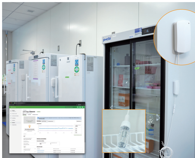
新木場ラボの冷凍庫・冷蔵庫に設置されている「Cisco Meraki MTセンサー」と、そのセンサーの温度情報がリアルタイムで表示されている「ダッシュボード画面」
